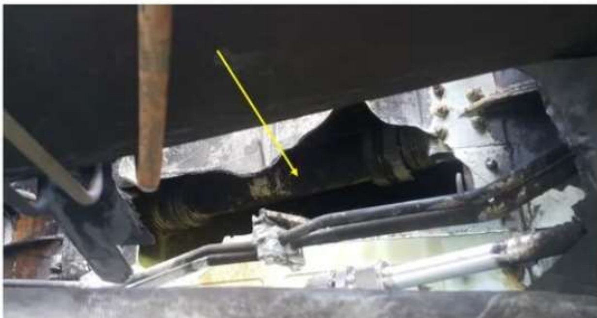
Рис. 15. Внешний вид гидроцилиндра управления правой ООШ
