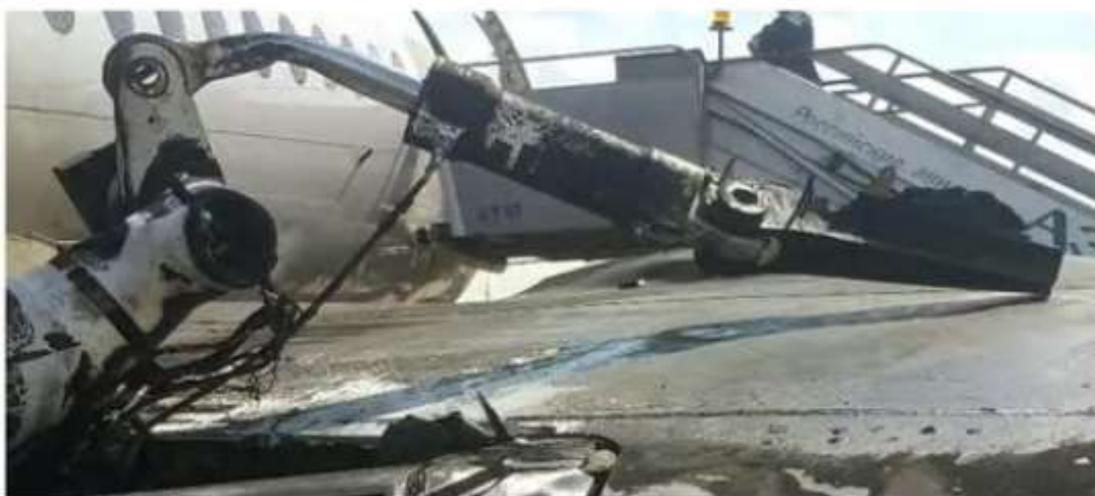
Рис. 15. Внешний вид гидроцилиндра управления правой ООШ
